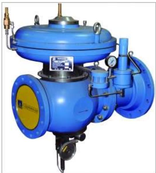
Регуляторы представляют единую конструкцию с клапаном регулирующим, устройством задания давления (пилотом), регулятором перепада для снижения высокого входного давления до давления питания и предохранительно-запорным клапаном (ПЗК), встроенным в регулятор.
